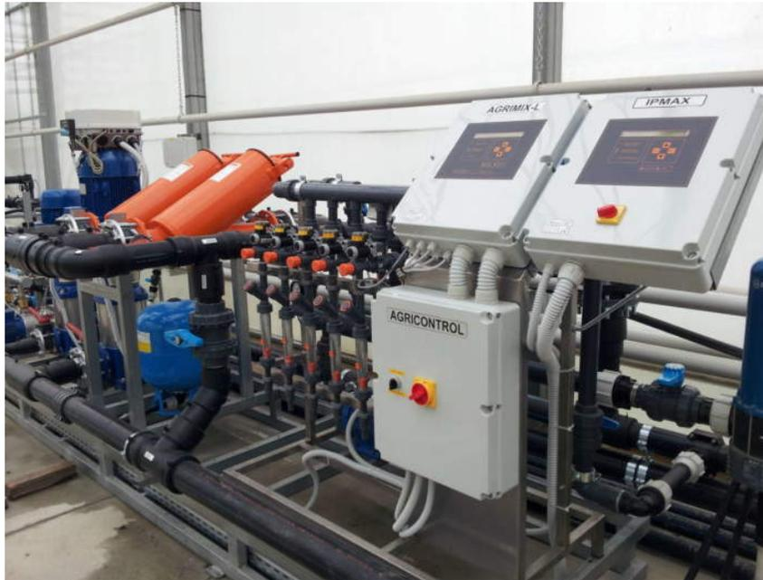
I banchi di fertirrigazione computerizzati della serie Agrimix-L consentono la miscelazione automatica, a seconda del modello, da due a sei soluzioni madre e di una soluzione acida per la
