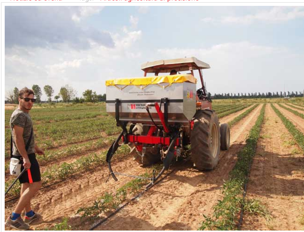
La concimazione del pomodoro da industria con tecnologia di precisione: in azione lo Spandiconcime VRT della Tecnovict
